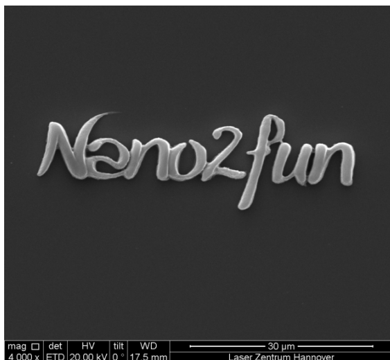
Figure 3. Imagen de microscopio electrónico de barrido de la estructura fabricada durante el entrenamiento práctico sobre 2PP.
