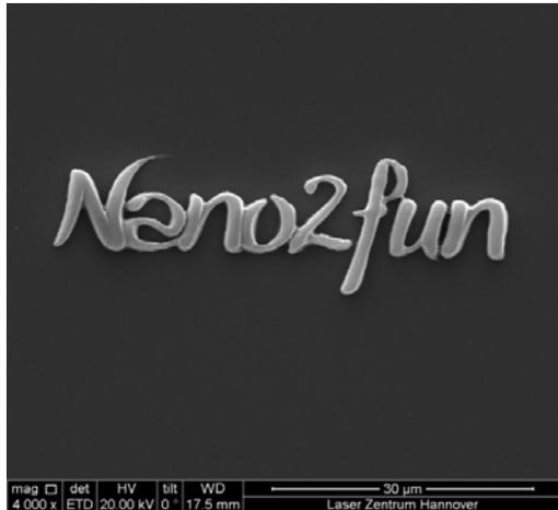
**Снимок со сканирующего электронного микроскопа полученной структуры**
