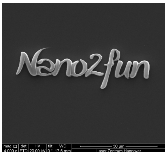
Figura 3. Imatge de microscopi electrònic d'escombrat de l'estructura fabricada durant l'exercici pràctic sobre 2PP.
