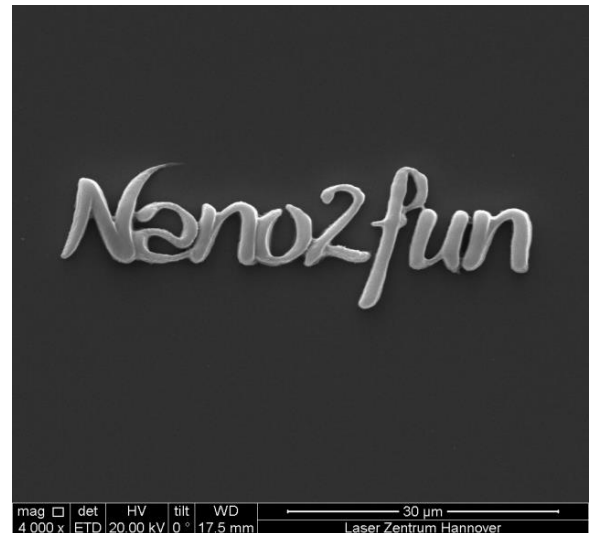
Здымак вырабленай запалімерызаванай структуры (атрыманы з дапамогай электроннага мікраскопа).
